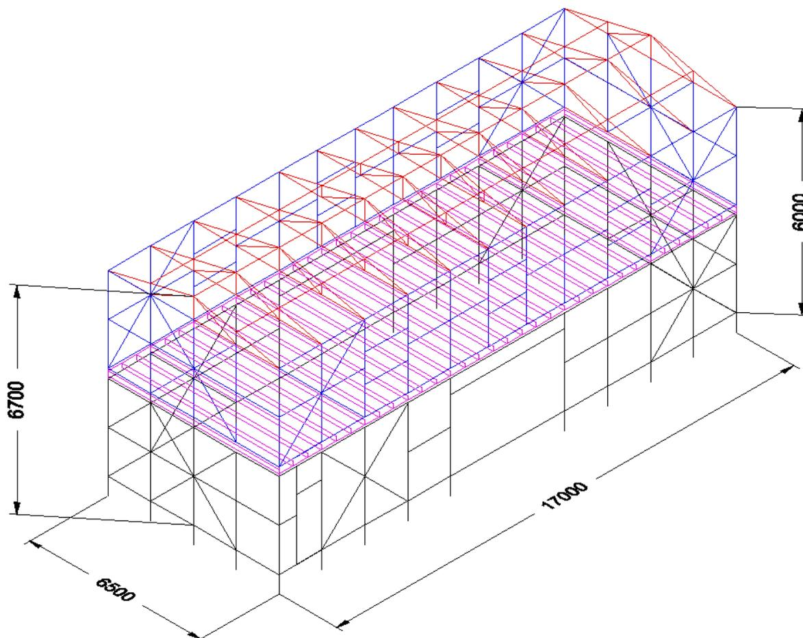
**Largeur = 6,5m    Longueur = 17m    avec H1= 6m et H2= 6,7m**
